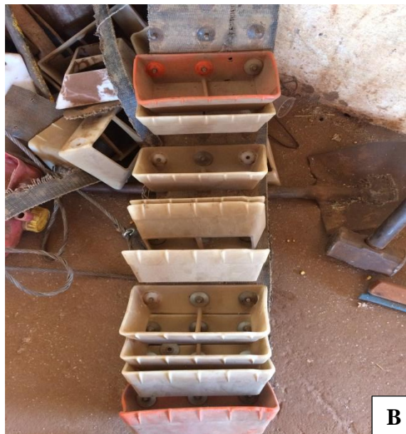
Figura 3: A) Alavanca responsável por fechar as bocas de alimentação no pé do elevador; B) Correia rompida pelo excesso de esforço e C) Manutenção no elevador após a ruptura da correia. Fonte: Arquivo pessoal.
